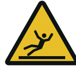
Warnung vor Rutschgefahr W011
