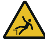
Warnung vor Absturzgefahr W008
